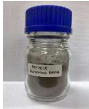
BE-Regenerated Dapat digunakan kembali Dengan kadar kandungan minyak tidak lebih dari 1,0%
